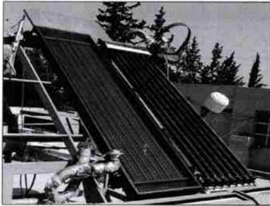
الشكل (5) اللاقط (المركب) على منصة الاختبار
